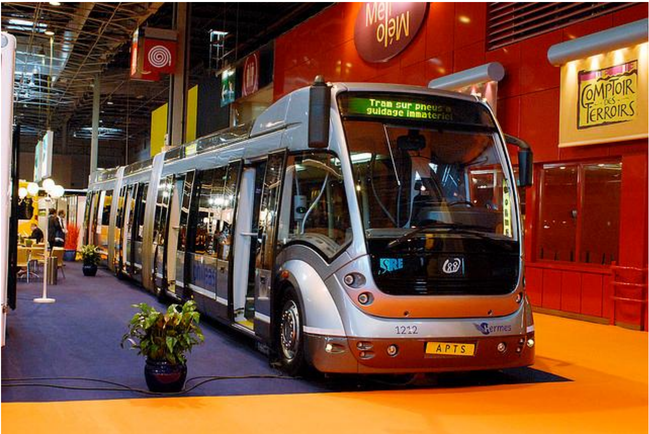
Toisen valmistajan moderni, kaksinivelinen linja-auto. Myös tässä voidaan kaikki akselit saada vetävinä.
